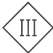
Dieses Symbol kennzeichnet elektrische Geräte, die der Schutzklasse III entsprechen.
