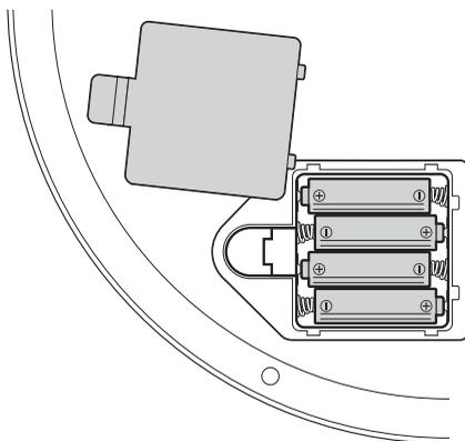
2. Introduza as pilhas fornecidas **11** exatamente conforme indicado na base do compartimento das pilhas **9**. Tenha atenção à polaridade correta das pilhas (+/-).
