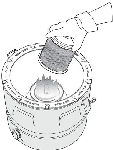
8. Coloque o recipiente com carvão com a tampa colocada na placa de ignição a queimar.
