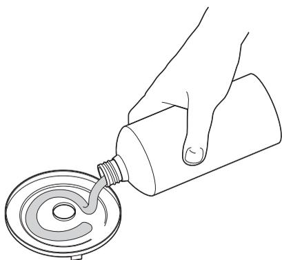
4. Aplique um anel de gel ignitor com cerca de 1 cm na placa de ignição **4**.
