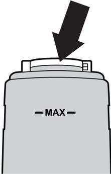
3. Drehen Sie das Rückschlagventil (siehe Pfeil) gegen den Uhrzeigersinn und nehmen Sie es ab.
