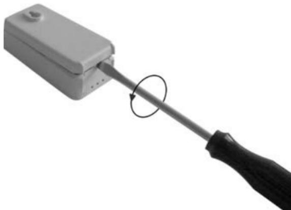
1. Entfernen Sie die Batteriefach-Abdeckung auf der Rückseite des Funksensors.
